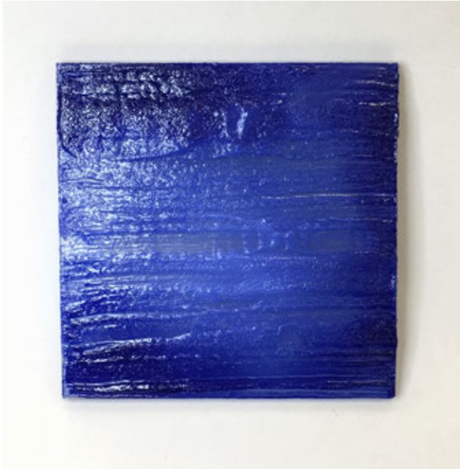
TP#1 Acrylglas (transparent, farblos) thermochromisches Pigment (Blau): 1g Acrylbinder: 8.8g
