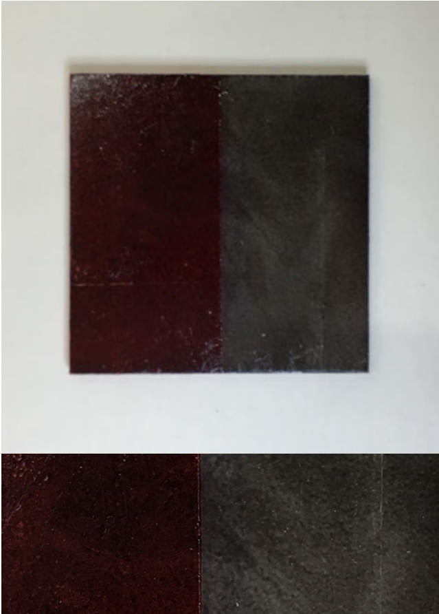
TP#7 thermochromisches Pigment (schwarz): 1g(20%) Ei Tempera Bindermittel: 4g(80%)
