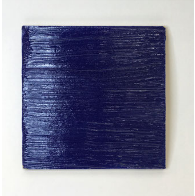
TP#1.2 HDF 3mm thermochromisches Pigment (Blau): 1g Acrylbinder: 8.8g
