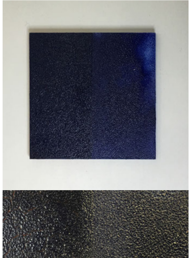
TP#10 thermochromisches Pigment (blau): 4g(40%) Ei Tempera Bindermittel: 6g(65%)
